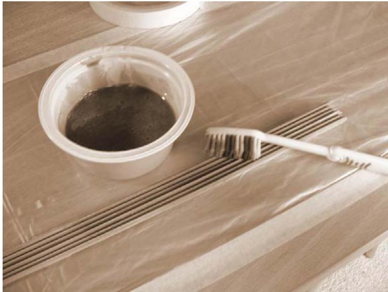
Bild: Offene Spleisse, Klebstoff und Zahnbürste zum Auftragen desselben
