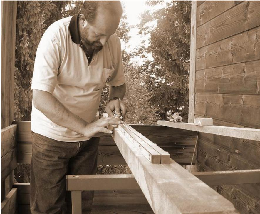
Bild: Nicht zu gebückte Haltung beim Hobeln, Hobelform auf Unterlage erhöht
