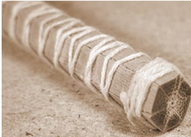
Bild: Spleisse fertig abgebunden
