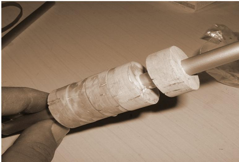
Bild: Korkringe werden auf Alustab geschoben und verleimt
