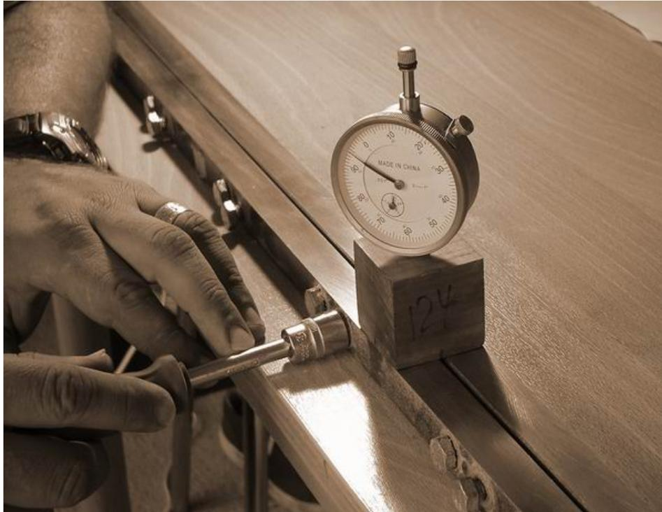
Bild: Einstellen der Messstationen mittels Schraubmechanismus. Beachte die Base aus Holz.
