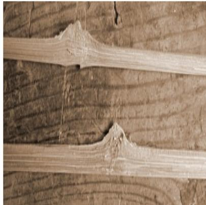
Bild: „Bambuszähne“ am Spleiss
