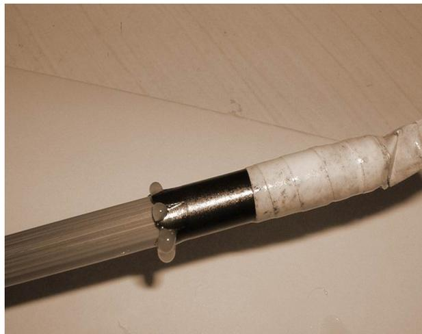
Bild: Hülse auf den Blank aufgeschoben, die Leimtropfen müssen abgewischt werden. Das helle Klebeband rechts auf der Hülse ist die Abdeckung für das Brünierbad.
